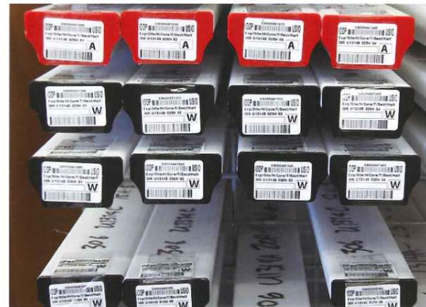
コアレジストリー(ドイツ・プレーメン大学)に保管された深海底堆積物のコア試料
