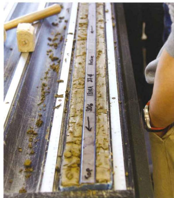
深海底堆積物のコア試料の切り出し作業
