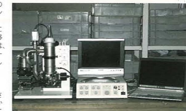
走査型電子顕微鏡Tiny-SEM(株式会社 テクネックス工房)
